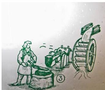
13. Au moyen de sa pince à feu, le forgeron maintient la masse métallique brûlante sous le marteau pilon. Explique comment celui-ci fonctionne et imagine d'où vient l'eau !
