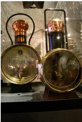
22. Les lanternes fonctionnaient avec du pétrole, avant l'introduction de l'éclairage électrique. Où les plaçait-on sur le train ?
